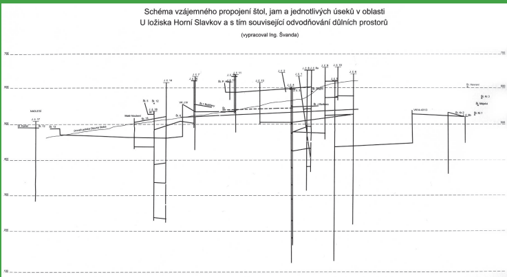
Schéma der Verbindung der Stollen, Gruben und der einzelnen Stollen im Gebiet der Schlagengruben Erzfeld und damit zusammenhängende Entwässerung der Bergbaubetriebe (Entworfen: Ing. Švanda)
